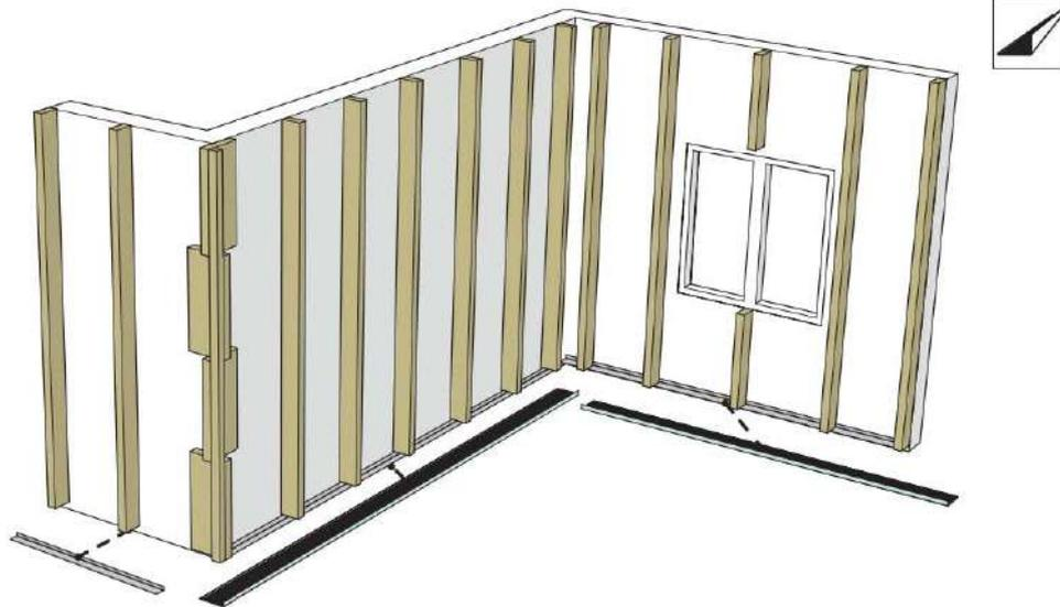
Stellen Sie sicher, dass die vertikale Lattung installiert ist. Montieren Sie dann die Lüftungsgitter an der Unterseite und bei einer Unterbrechung der Fassade. Die Lüftungsgitter sollen mit einem freien Luftdurchlass von mindestens  $200 \text{ cm}^2$  pro  $\text{m}^2$  montiert werden.
